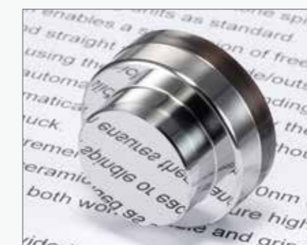
材質 焼入れ材SUJ2 (硬度HRC60) 表面粗さ Rz0.06 μm 使用砥石 CB#1,000
