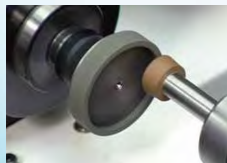
ツルレーング動作の様子
