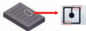
(新技術) 真鍮を溶着させながら加工し、中子を落とさずに切り離すことができます。
